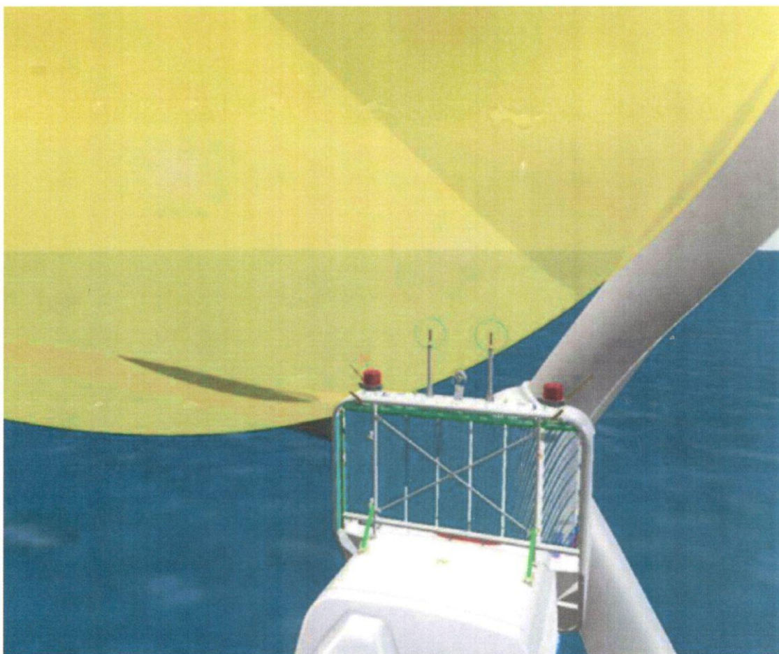
Ilustracja 6.4: Obliczenia w ramach metody toczącej się kuli dla CoolerTop® (Wersja Mk 2)
